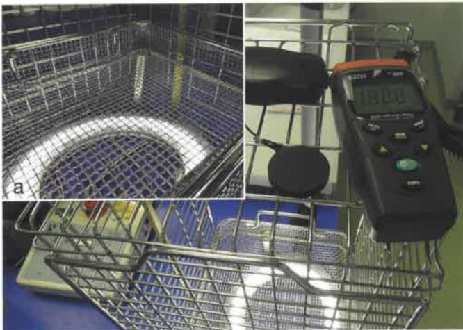
Abb. 4: Versuchsaufbau: oben liegend Luxmeter zur Messung der Lichtstärke, Gerüst: 1-STE-Drahtkorb, unten liegend Lichtquelle (LED-Lupenlampe), darüber das Sieb als Lichtfilter (siehe Abb. 4a).
